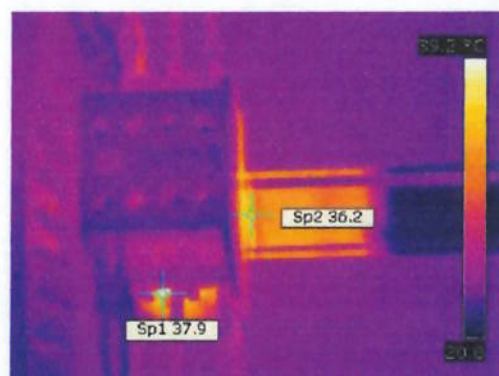
Figura 25 – Termograma da base fixação de contator com reflexão.
