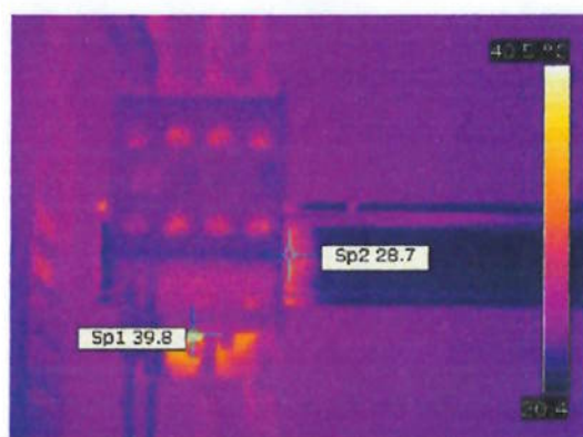
Figura 26 – Termograma da base fixação de contator com a reflexão reduzida.
